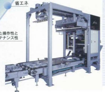
トヨー高速メカパレと東洋ソニックパッカーとの組み合わせで出荷工程の大幅な効率化がはかれます。
